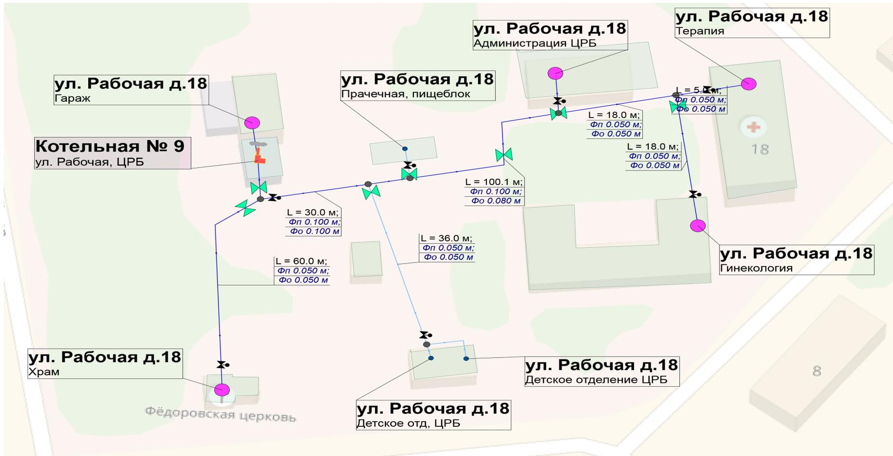
Рисунок 1.3 – Схема тепловых сетей котельной № 9 п. Парфино, ул. Рабочая ЦРБ
