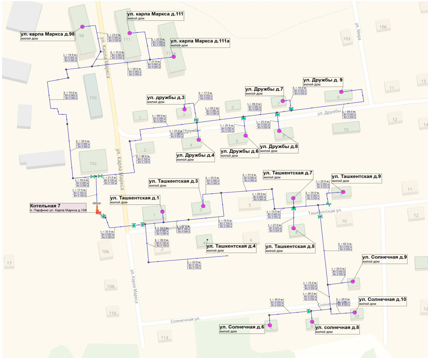
Рисунок 1.1 – Схема тепловых сетей котельной № 7 п. Парфино ул. Карла Маркса д.104
