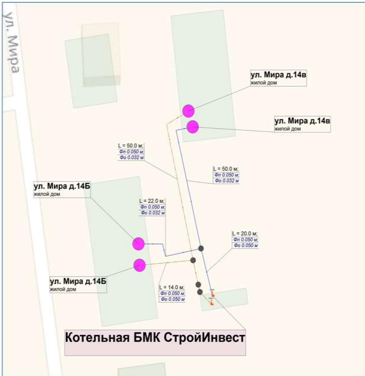
Рисунок 5. Схема тепловых сетей БМК "Стройинвест"
