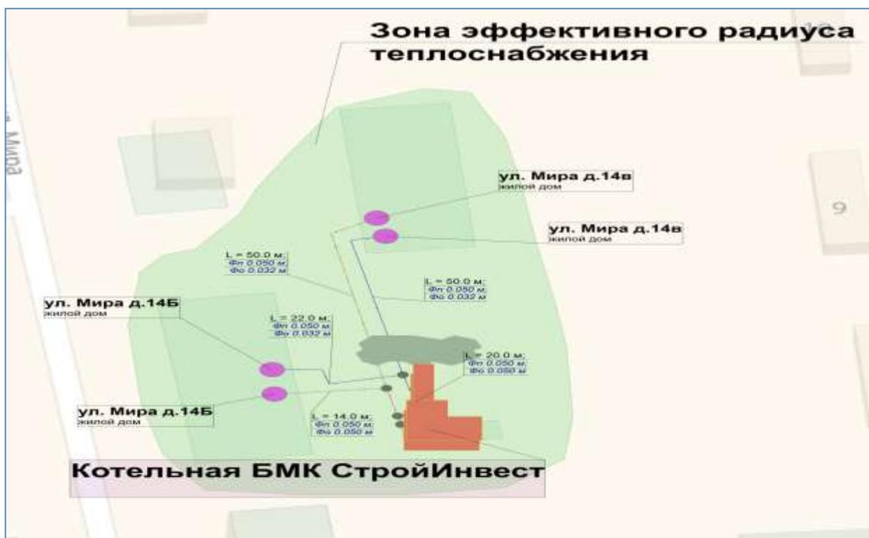
Рисунок 12: Зона эффективного радиуса теплоснабжения БМК «СтройИнвест»
