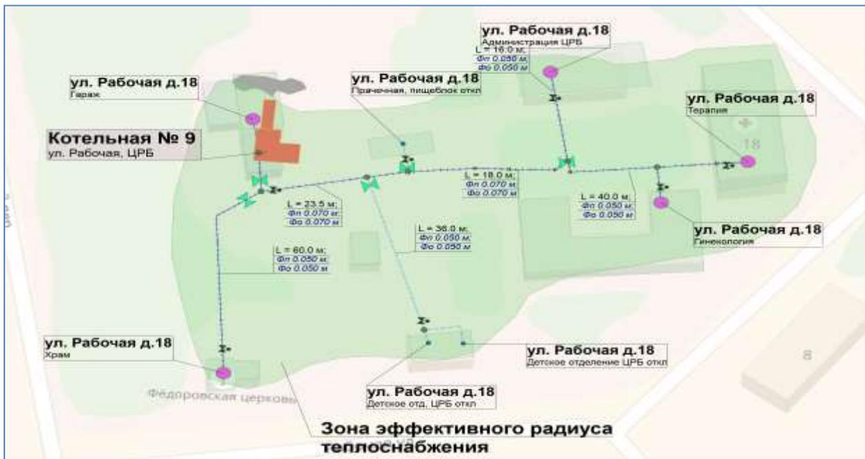
Рисунок 9: Зона эффективного радиуса теплоснабжения Котельной №9
