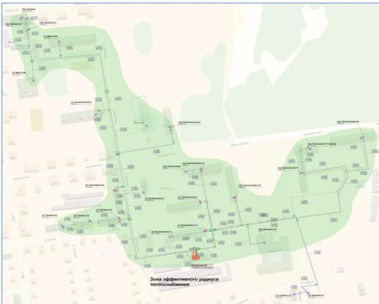
Рисунок 10: Зона эффективного радиуса теплоснабжения котельной №10
