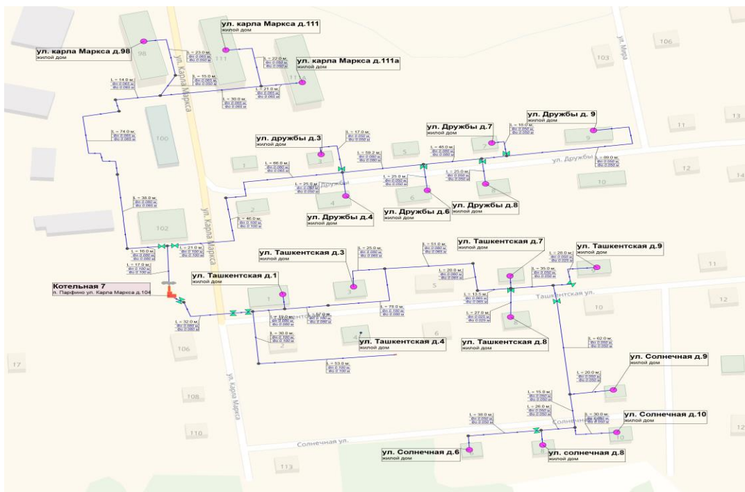
Рисунок 1.1 – Схема тепловых сетей котельной № 7 п. Парфино ул. Карла Маркса д.104
