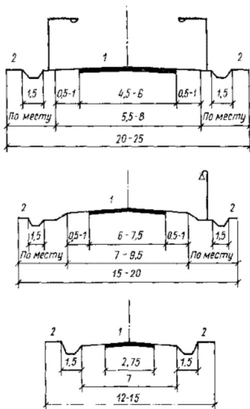
Рис. 1. Типовые поперечные профили поселковых дорог
