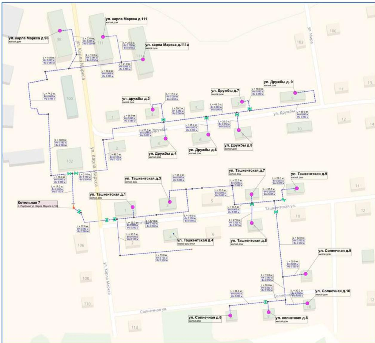
Рисунок 1. Схема тепловых сетей котельной № 7
