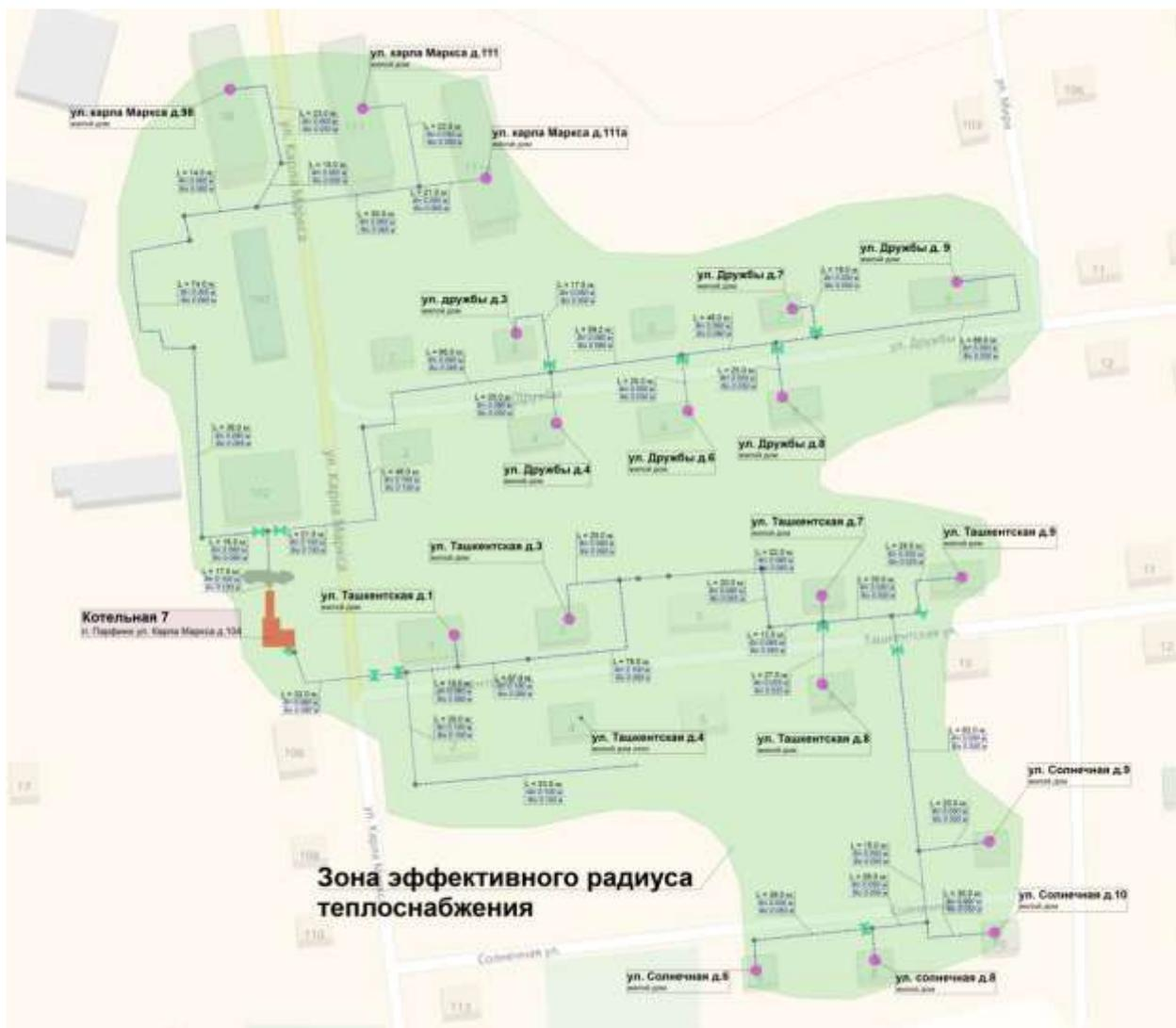
Рисунок 7: Зона эффективного радиуса теплоснабжения котельной №7
