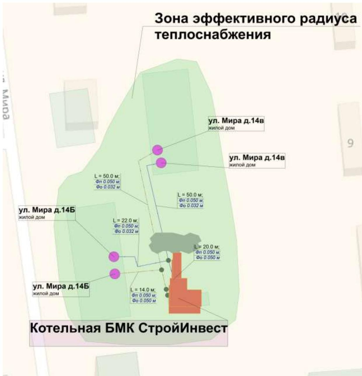
Рисунок 12: Зона эффективного радиуса теплоснабжения БМК «СтройИнвест»
