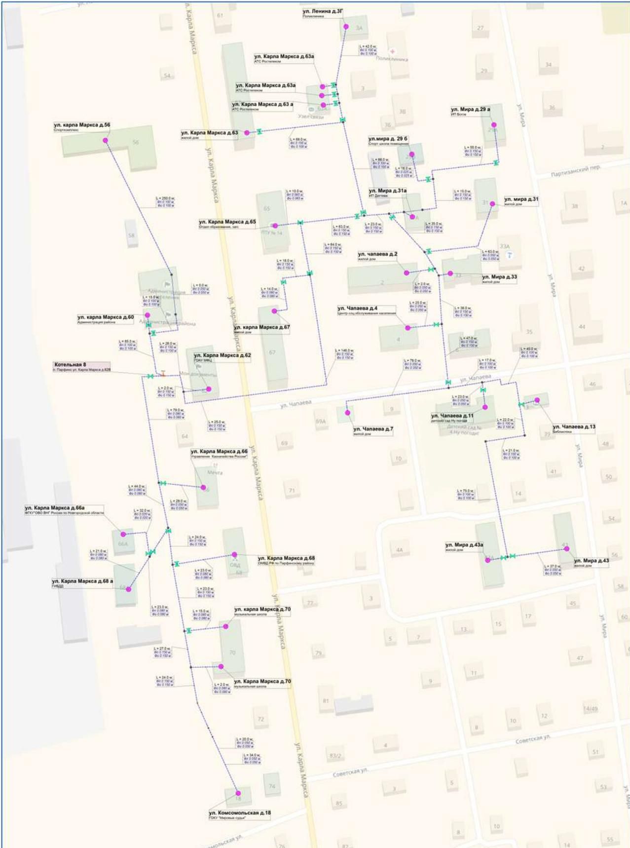
Рисунок 2. Схема тепловых сетей котельной № 8
