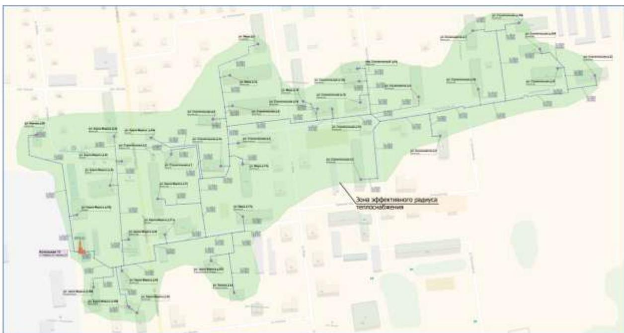
Рисунок 11: Зона эффективного радиуса теплоснабжения котельной №13
