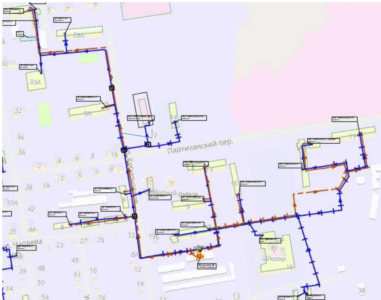
Рисунок 4. Схема тепловых сетей котельной №10
