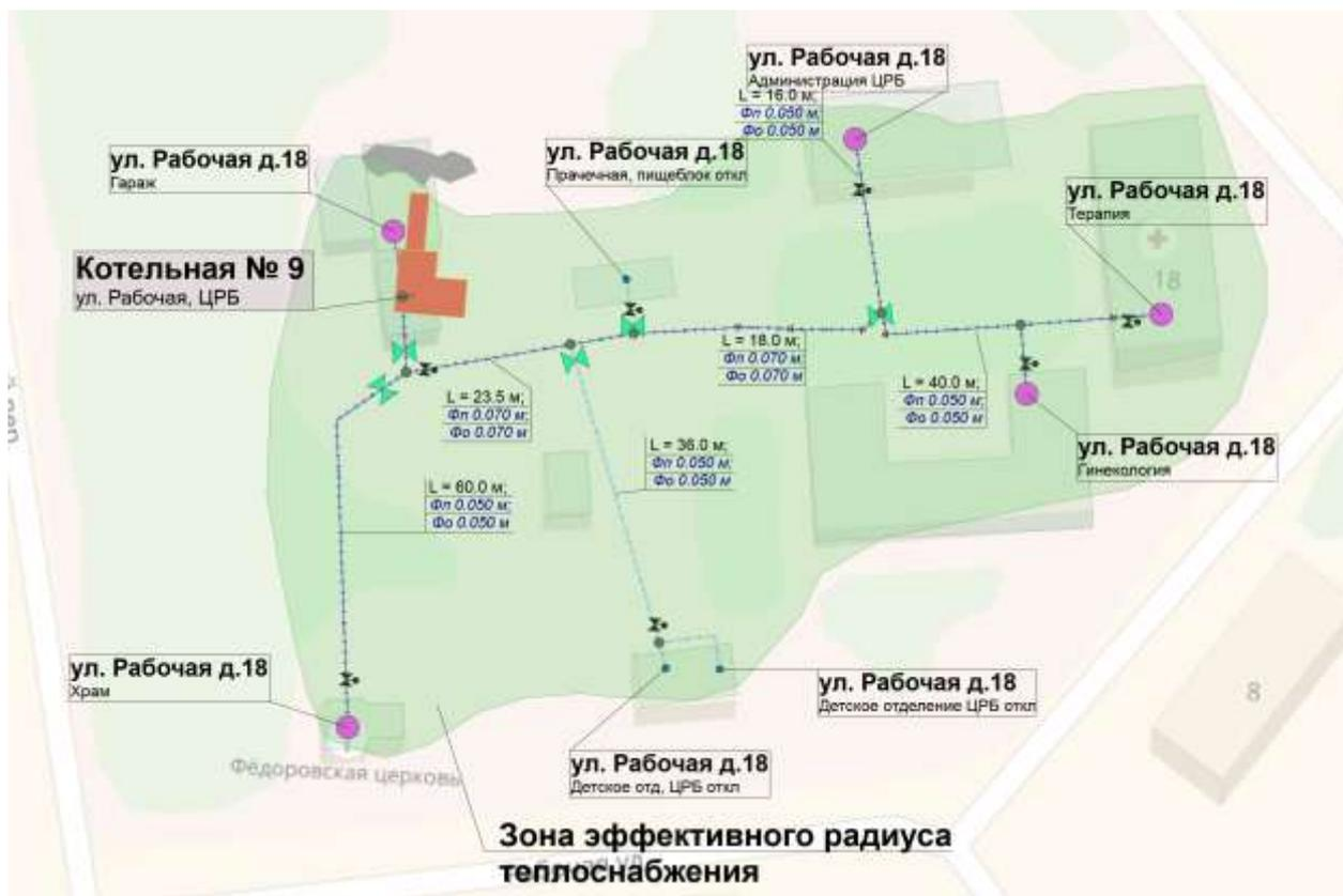
Рисунок 9: Зона эффективного радиуса теплоснабжения Котельной №9
