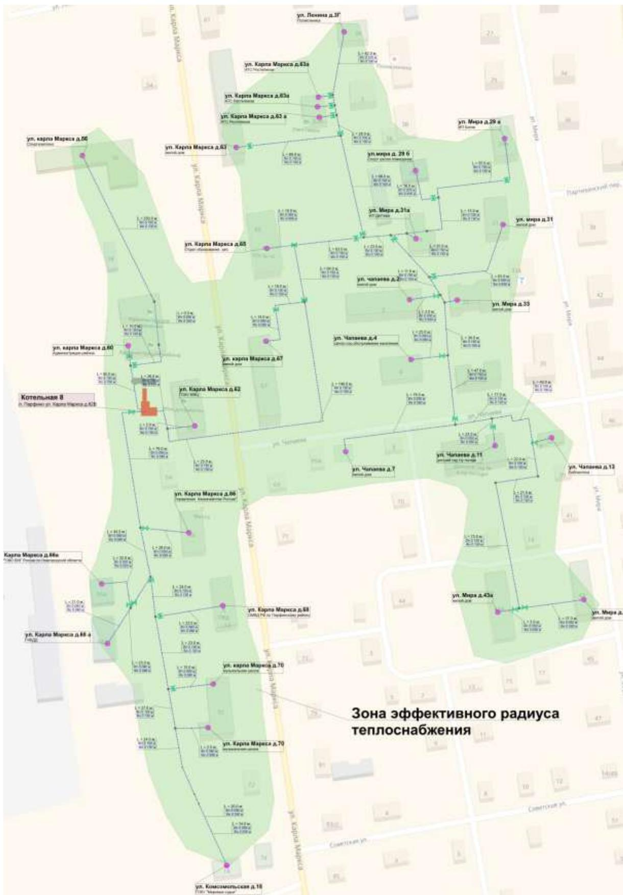
Рисунок 8: Зона эффективного радиуса теплоснабжения котельной №8
